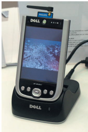
КПК с картой расширения компании Philips может показывать цифровое ТВ
