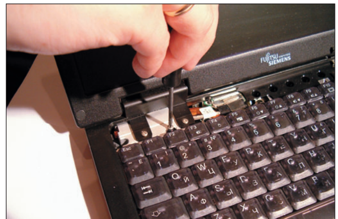
...и открутите тонкой крестовой отверткой
