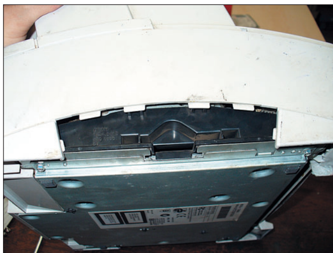
Рис. 2. Здесь можно увеличить объем ОЗУ принтера
