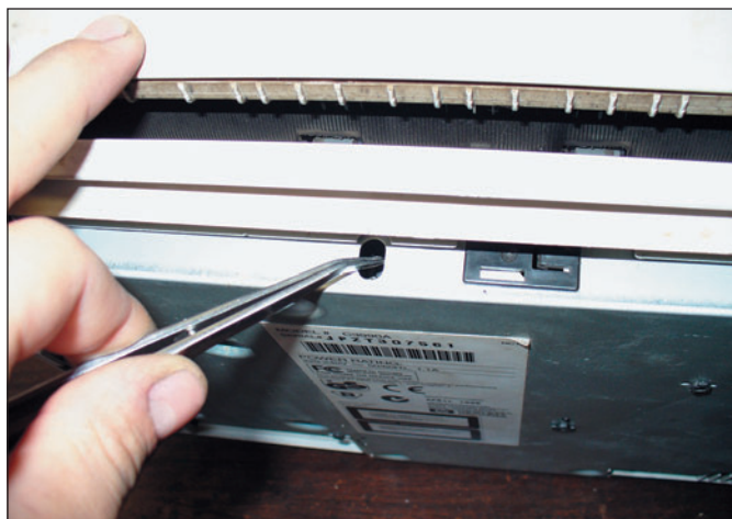
Рис. 3. В этом отверстии спрятана кнопка для печати так называемой «инженерной» страницы
