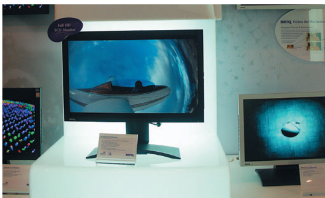
Один из первых ЖК-мониторов с разъемом HDMI, позволяющим дисплею воспроизводить сигнал 1080p
