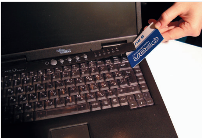
Пластиковой карточкой аккуратно подденьте край фальшпанели, закрывающей винты крепления клавиатуры...
